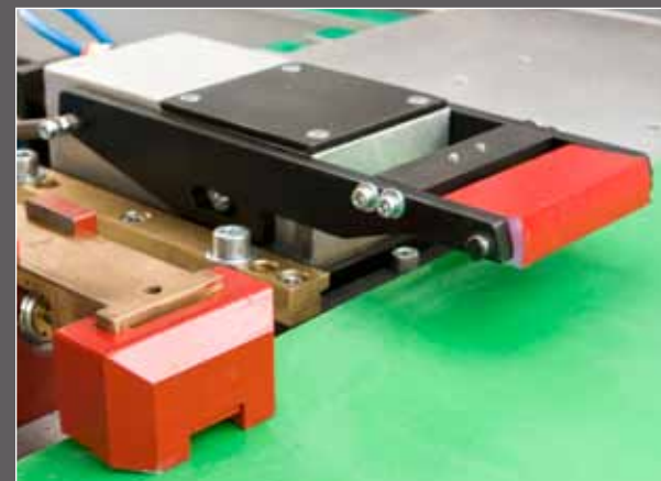
Gruppo di regolazione rotazione della tavola in nylon autoregolabile ad ogni fine ciclo. Regulating unit rotation of the table, self-adjusting nylon loop at each end.
