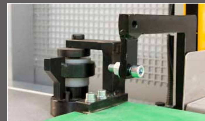
Gruppo pinza e rismatore pneumatici programmabili retrattili. Group rismatore clamp and programmable pneumatic retractable. Grupo rismatore pinza neumática, retráctil y programable.
