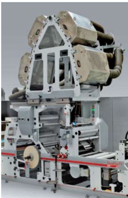
Секция ламинации сольвентными клеями, устанавливаемая в линию на машины VaryFlex
